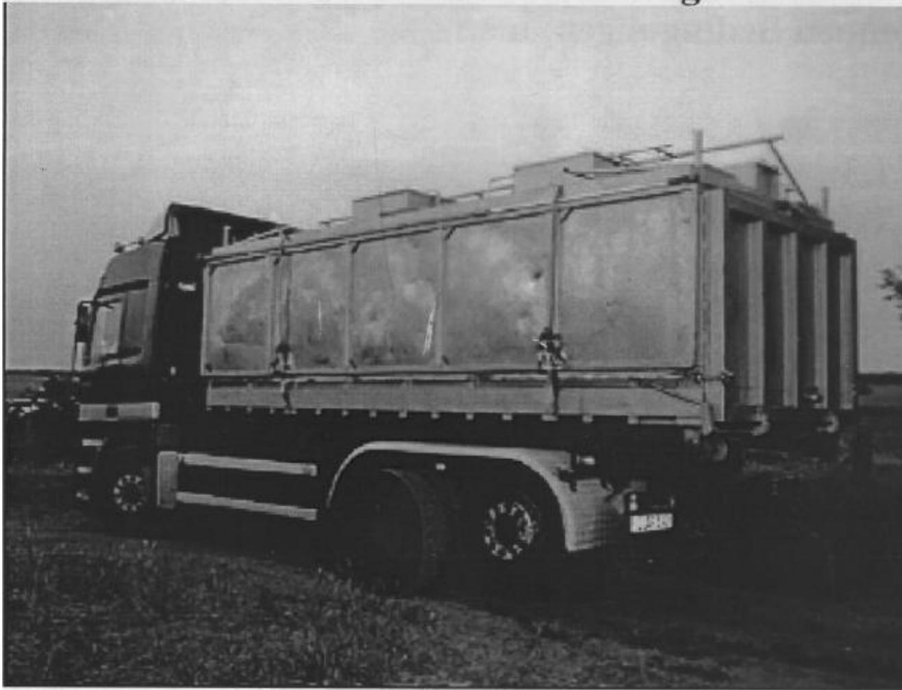
**Bild 2 Fahrzeug mit SRM-Container und Spezialdeckel**
