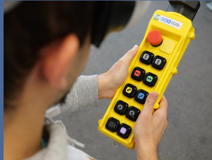
Der VR KRANTRAINER für Brückenkrane im Einsatz. Die integrierte Mixed-Reality-Technologie ermöglicht die Bedienung mit Blick auf die Kransteuerung (Bild rechts unten).
